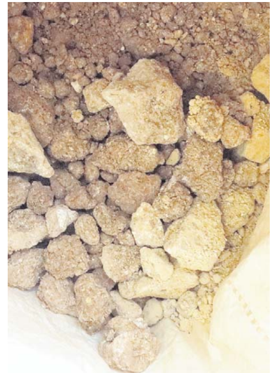
Tonnenweise wird das Gestein mit Wasser und giftigem Quecksilber zermahlen. Die Ausbeute an Gold beträgt trotzdem nur wenige Gramm. Foto: O. Ristau
