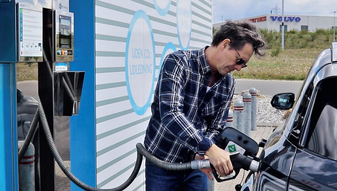
**Fast wie gängiger Sprit:** Wasserstoff fließt als minus 40 Grad kaltes Gas in den Tank und wird dann im Auto wieder „verstromt“. Mit einem Kilo kommt ein Wasserstoffauto etwa 100 Kilometer weit
