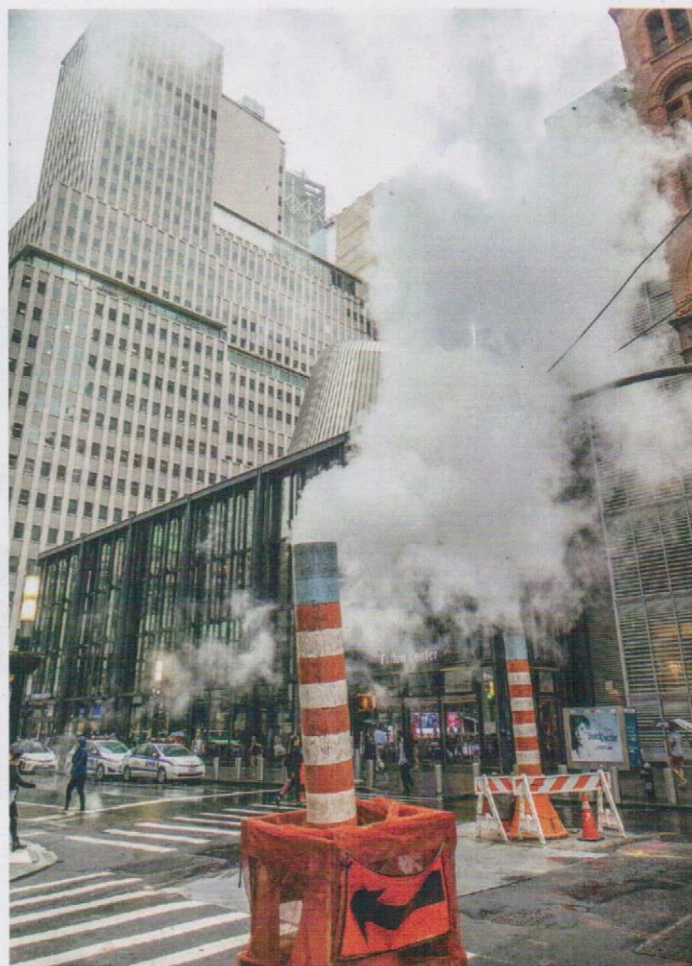
Wasserdampf als Heizung: Das Netz dafür ist 125 Jahre alt, die Wärme wird mit fossilen Energien erzeugt
