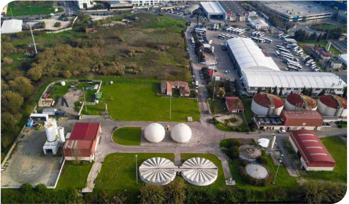
Portugal erzeugt einen großen Teil seines Biogases mit Klärgas. Hier die Anlage von Frielas, die das Biogas auch zu Biomethan aufbereitet.
