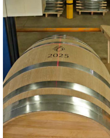
Je nach Kundenwunsch und Verwendung graviert ein Laser die Beschriftung der fertigen Fässer.
