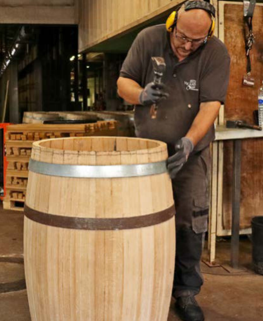
Bei Vicard fügen sie seit 2023 die Dauben mit Nut und Feder zusammen.
