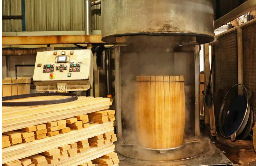
Wasserdampf ermöglicht, das Holz behutsam in Form zu bringen. Foto rechts: Mit geübten Hammerschlägen platziert der Küfer die Metallringe.
