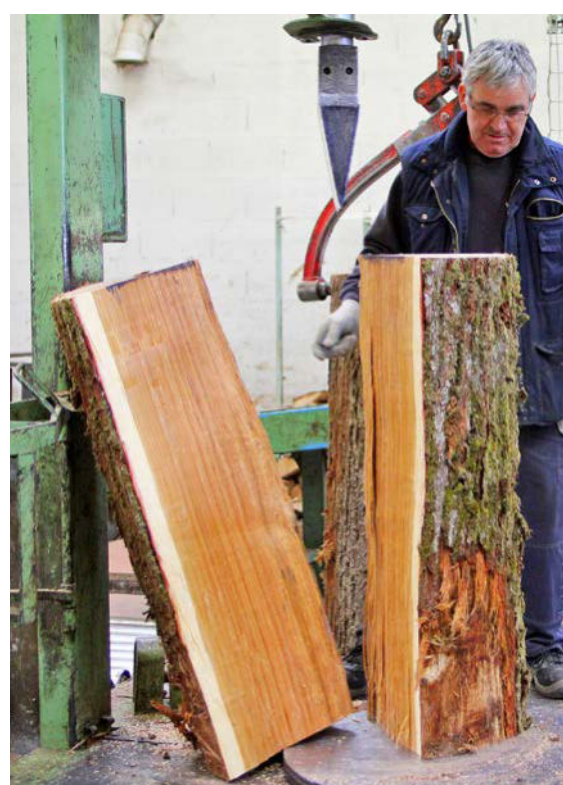
Das Spalten der Stammstücke ist der erste Schritt auf dem Weg zur Daube.
